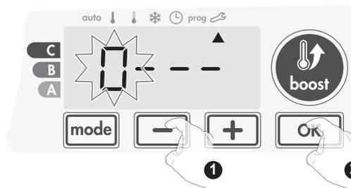
2- Pour les chiffres restants, sélectionnez le chiffre 0 par appui sur **OK**.
