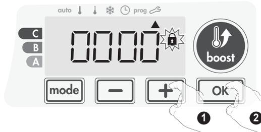
Le code PIN est initialisé, l'appareil vous propose automatiquement le réglage suivant : activation du code PIN.
