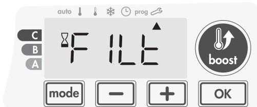
Avant toute opération de retrait du filtre, arrêtez l'appareil en appuyant sur le bouton (commutateur) situé au dessous de la soufflerie.
