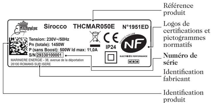
**Important :** le numéro de série permet au fabricant d'identifier votre appareil.
