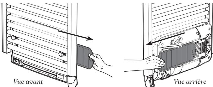
2- Utilisez un aspirateur pour éliminer la poussière déposée sur le filtre. Si le filtre est très sale, lavez-le sous le robinet d'eau avec une éponge humide. Après avoir lavé le filtre, laissez-le bien sécher.
