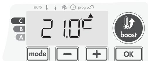
Augmentez de 2°C la température mesurée par la sonde à l'aide de la touche **+**.
