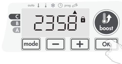
4- Appuyez sur **OK** une nouvelle fois pour sortir du mode de paramétrage du code PIN et revenir à l'écran d'accueil des réglages installateur.
